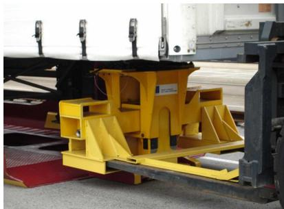
Etape 4 : Le chariot à fourche recule l'ensemble semi-remorque / interface dans la corbeille jusqu'à obtention du verrouillage de l'interface sur la corbeille.
