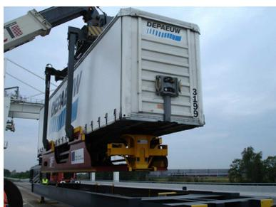
Etape 9 : En fin de dépose, l'interface se verrouillera sur le châssis du wagon, sécurisant l'ensemble semi-remorque / corbeille / châssis du wagon.
